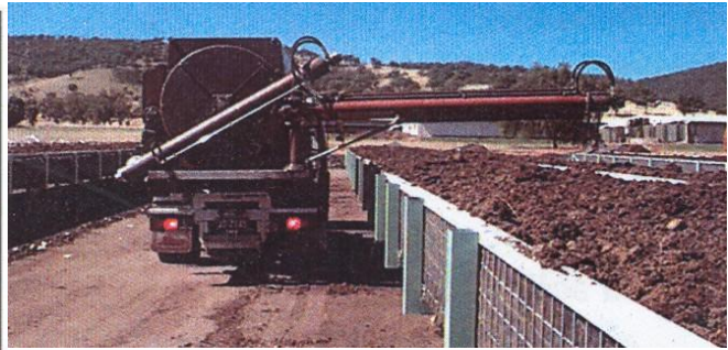
Фигура 2. Общ вид на устройства за полагане на субстрата (утайката) върху реактора-легло а) – при повдигнат реактор-легло в закрито помещение; б) – при повдигнат реактор-легло на открито
