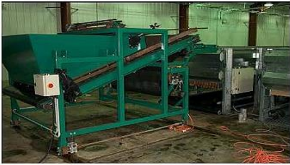
Фигура 2. Общ вид на устройства за полагане на субстрата (утайката) върху реактора-легло а) – при повдигнат реактор-легло в закрито помещение; б) – при повдигнат реактор-легло на открито
